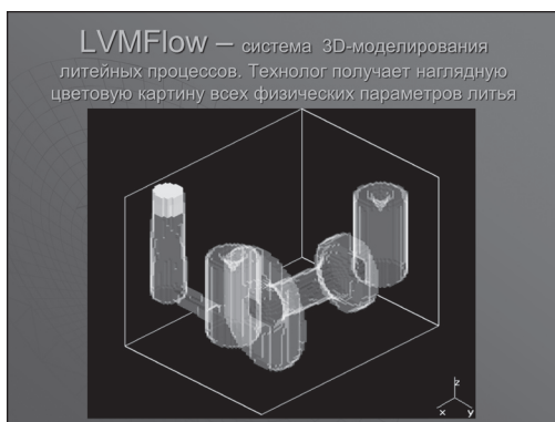
Рис. 5. Слайд 5 «LVMFlow — система 3D-моделирования литейных процессов»
