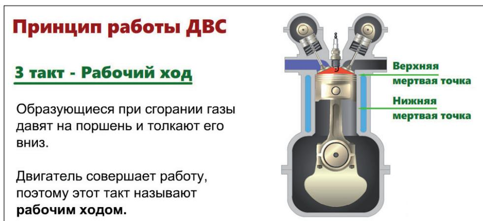
Рис. 3. Принцип работы ДВС
