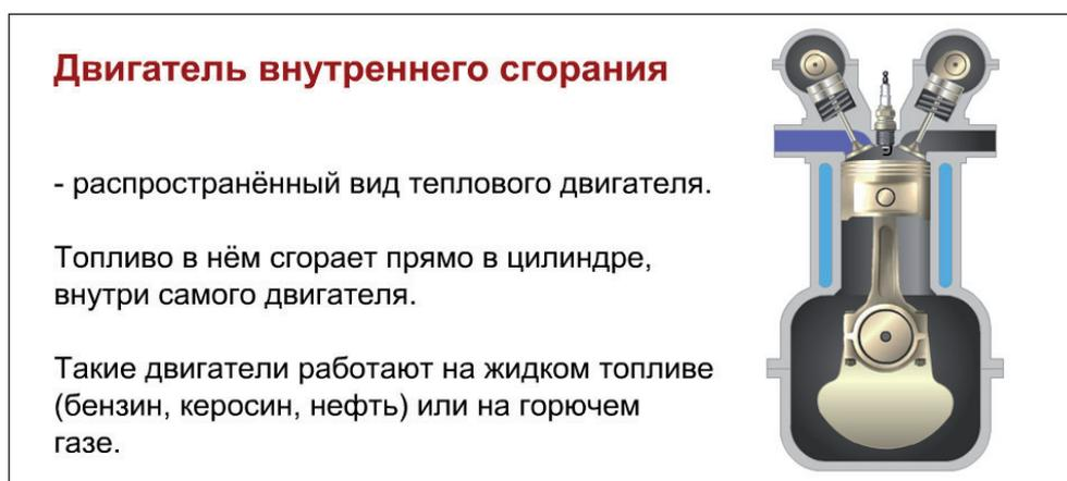
Рис. 2. Двигатель внутреннего сгорания
