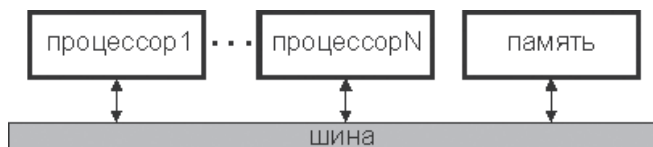
Рис. 3. Многопроцессорный компьютер с общей памятью
