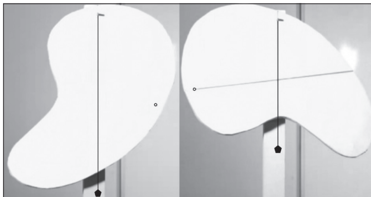
Рис. 1. Определение центра тяжести плоской фигуры: два кадра анимации, которую можно найти в Википедии по ключу поиска «Центр тяжести»
