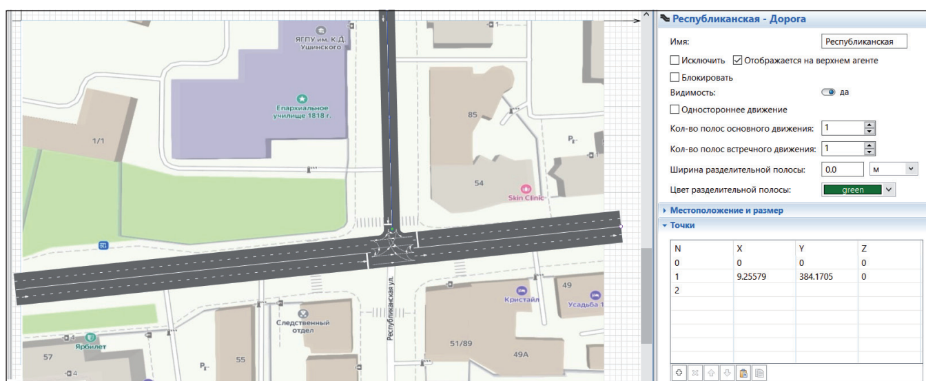
Рис. 2. Построение второстепенной дороги на улице Республиканской
