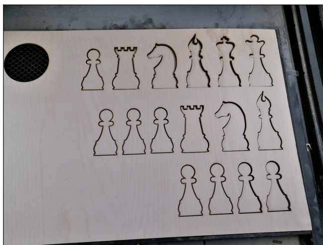
Фото 5. Работа лазерного станка окончена
