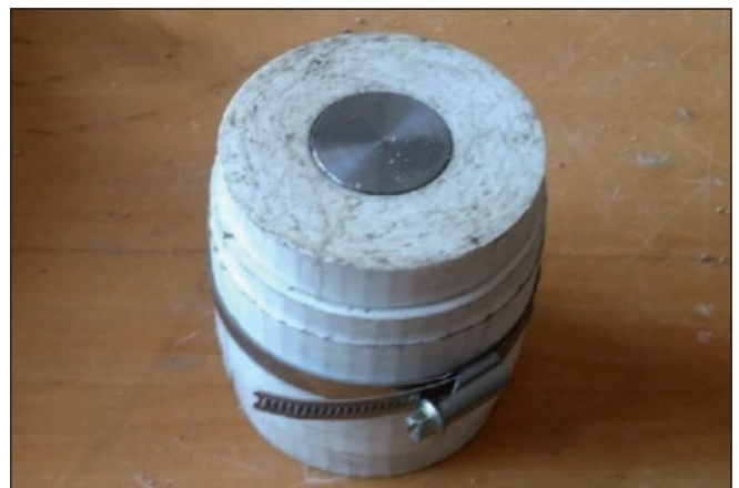
Фото 2. Готовая пресс-форма для изделия «изолятор»
