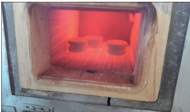
Фото 3. Обжиг керамического изделия «изолятор»
