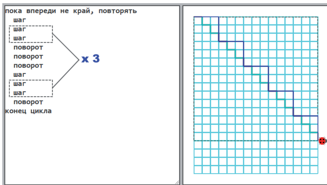
Рис. 2. Программа рисования лестницы используется в качестве вспомогательного алгоритма для перемещения исполнителя по диагонали квадрата. Пунктиром обведены команды, добавление которых позволяет значительно ускорить попадание исполнителя в конечную точку
