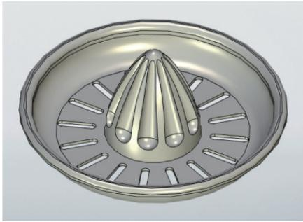
Рис. 27. Модель соковыжималки для цитрусовых
