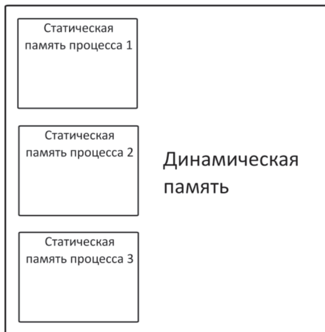
Рис. 1. Три программы, размещенные в памяти компьютера
