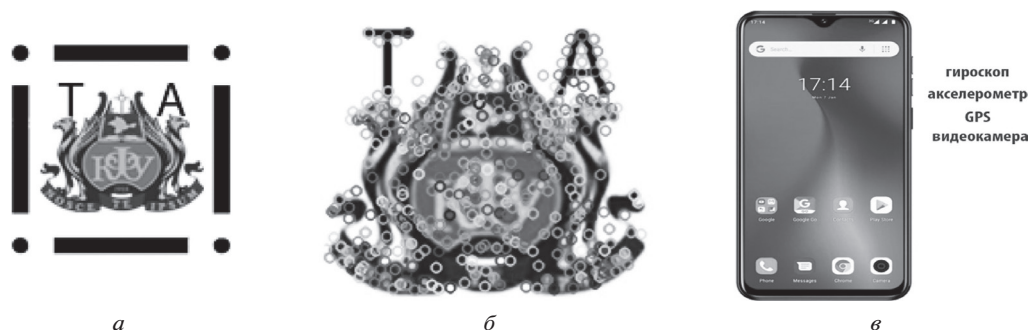
Рис. 1. Основные элементы технологий при создании приложений дополненной реальности: а — маркерная технология с примером создания маркера в EV Toolbox; б — безмаркерная технология с выделением опорных точек в SIFT; в — пространственная технология
