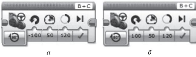
Рис. 11. Блок «Рулевое управление»: а — поворот налево, б — поворот направо
