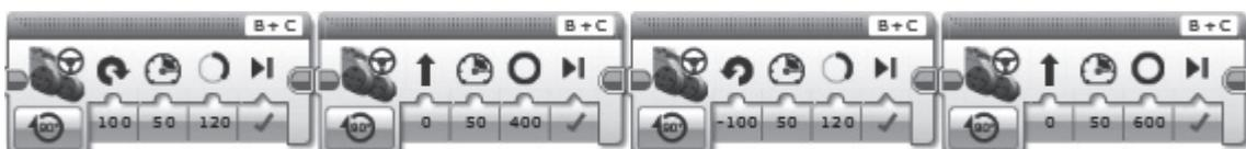
Рис. 22. Программирование объезда камня слева
