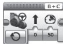
Рис. 8. Блок «Рулевое управление» в режиме «Включить»
